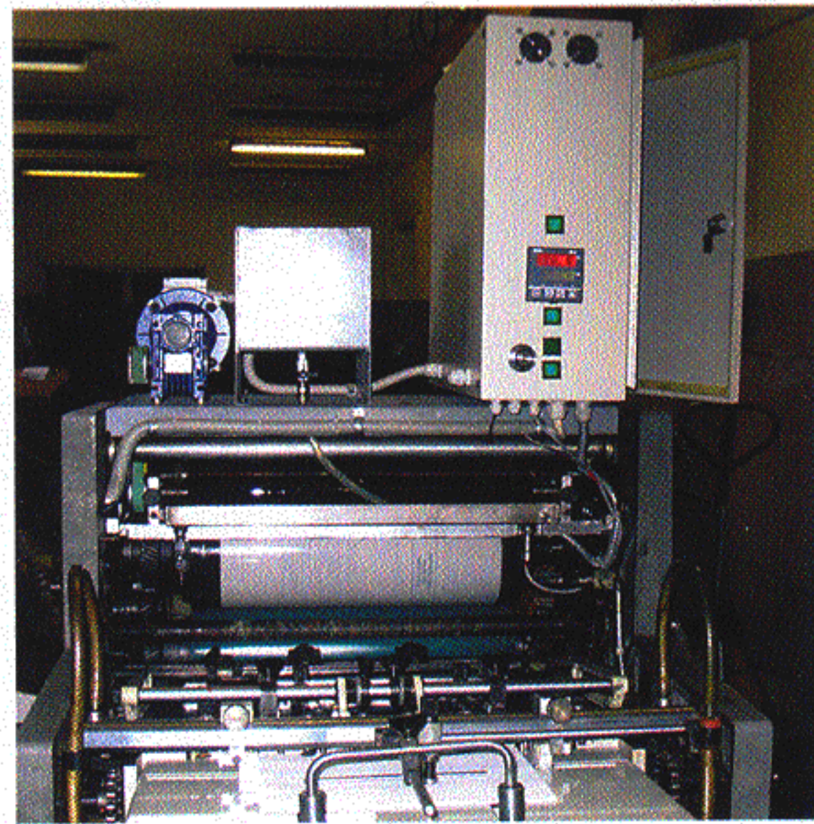
Лакировальный аппарат MINI COATER 490, установленный на модернизированный ROMAYOR 314
